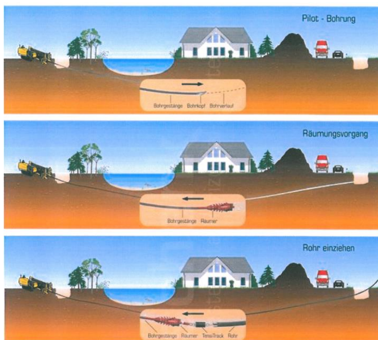
Abbildung 109: Ablauf grabenfreier Einzelrohrvortrieb (Quelle: schenkag.com, 2018)
