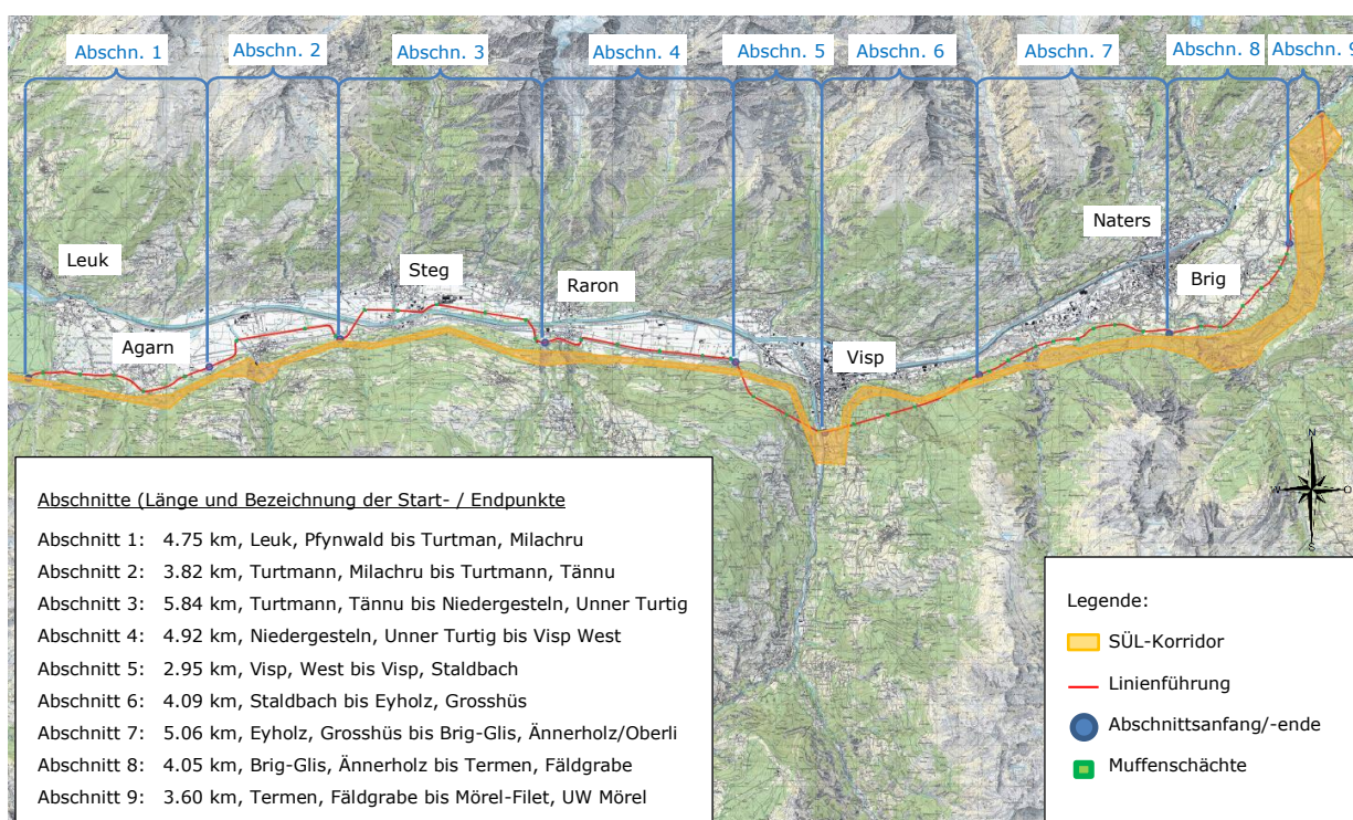
Abbildung 15: Übersicht Trasseverlauf Verkabelung Agarn - Mörel
